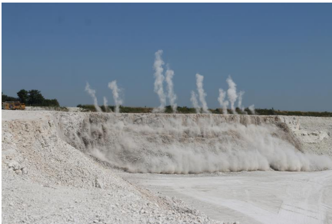
Augenblick der Sprengung im Kalksteinbruch
